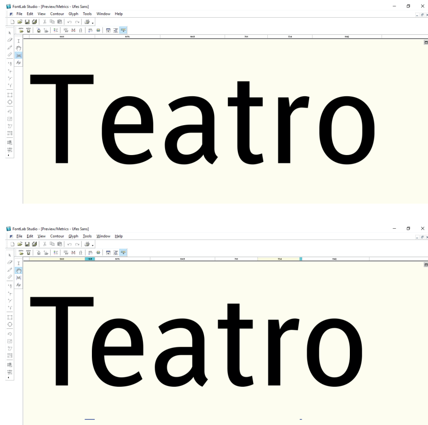
Figura 50 e 51 – Comparação entre a fonte Ufes Sans sem ajustes de kerning e com os ajustes aplicados aos pares de letras “T” e “e” e “r” e “o”.
